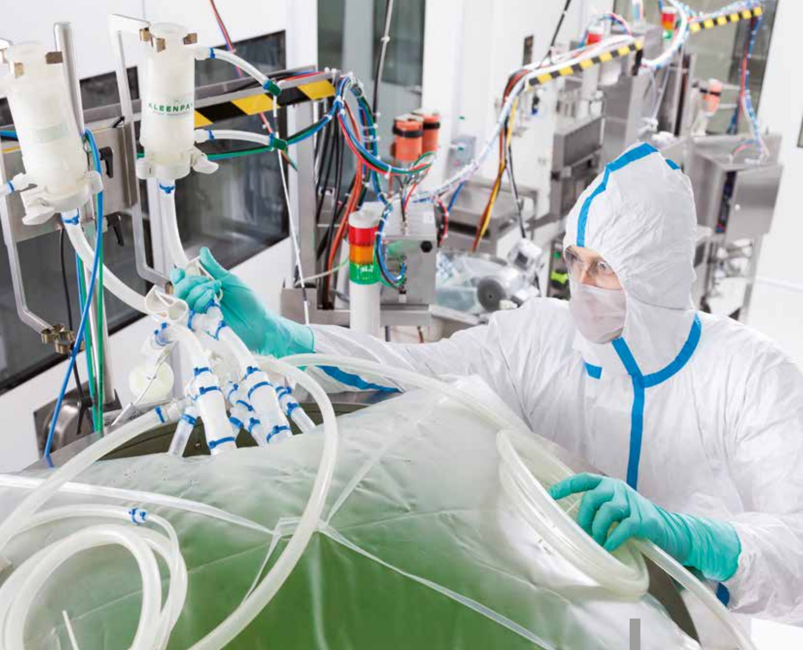
Przygotowanie jednorazowego bioreaktora wykorzystywanego podczas produkcji biotechnologicznej Preparation of single use bioreactor used in biotechnological production
