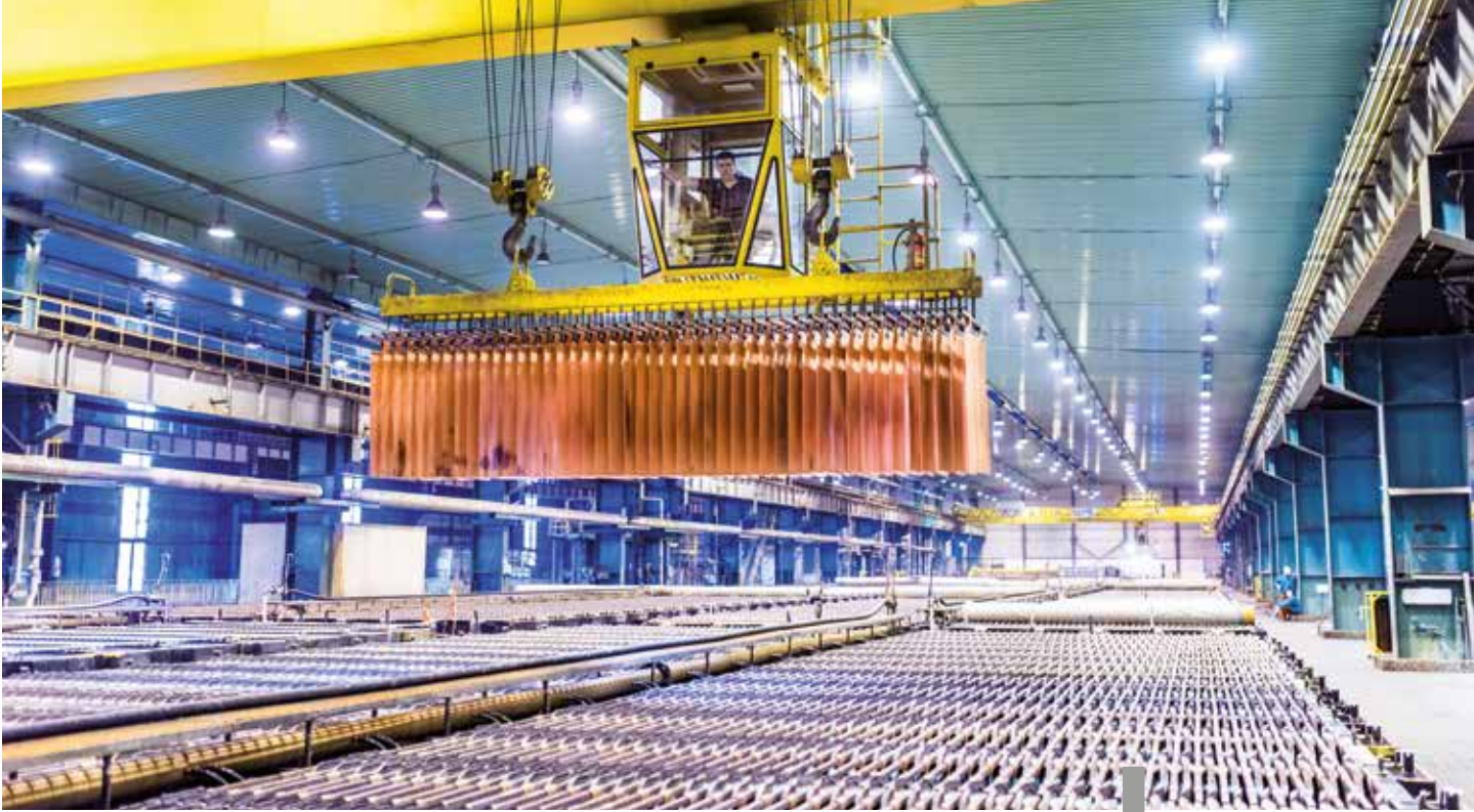
Hala elektorafinacji Huty Miedzi Głogów II. Suwnica przy pomocy trawersy transportuje katody Cu. Electrorefining Hall at the Głogów II Copper Smelter/Refinery. Transport of Cu cathodes using an overhead crane and crossbar.
