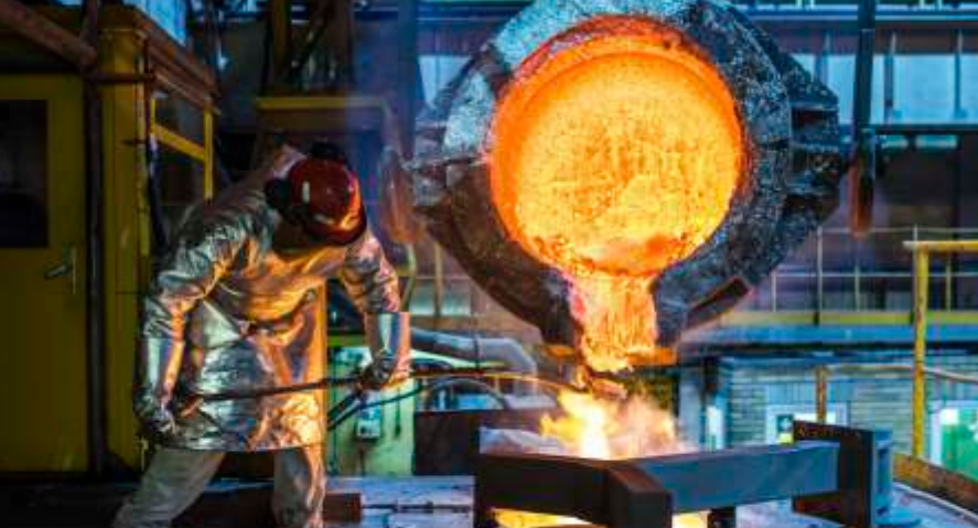
Huta Miedzi Głogów, Wydział Metali Szlachetnych. Proces wsadowania pieca anodowego przy użyciu kadzi tzw. Metalem Dorra, który zawiera ok. 99 % srebra pochodzącego z pieca Kaldo
